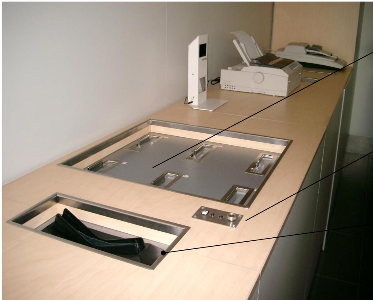
Депозитный модуль на 6 ячеек с инкассаторским и мешками
