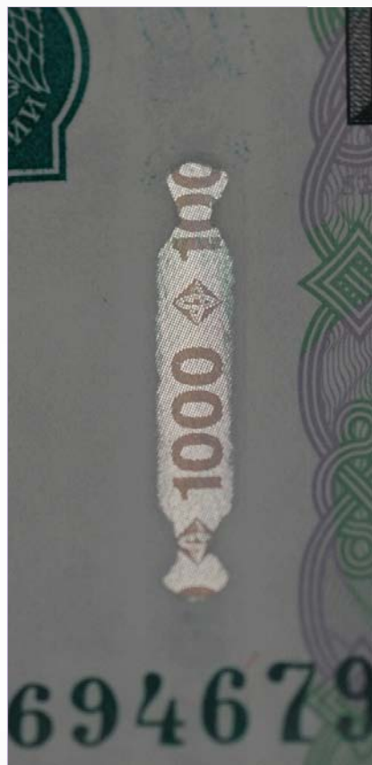
Защитная нить SKATE, введенная методом VFI
